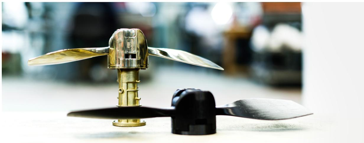
英国的一家制造公司 Sylatech 利用 3D 打印来确认生产前的物品尺寸是否准确，以及是否能发挥预期用途。在满足设计要求时，将使用这些物品通过熔模铸造制造金属部件。
