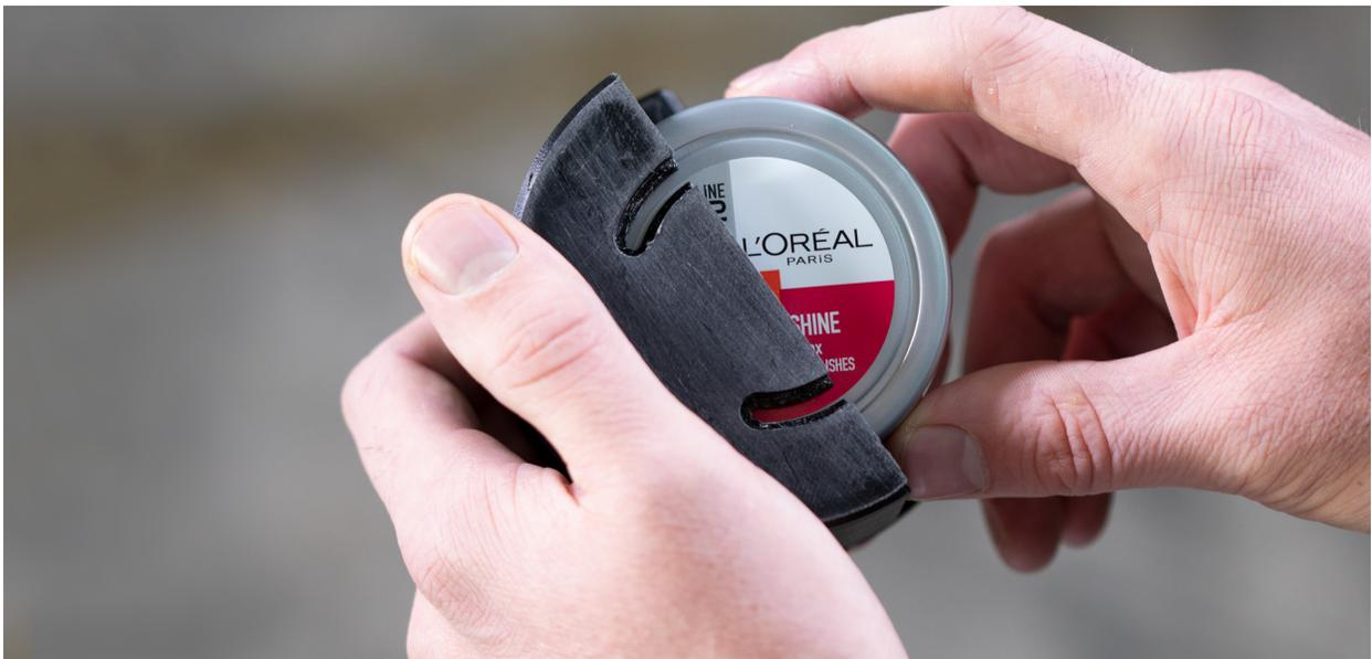
全球领先的美妆公司欧莱雅采用 3D 打印的制造辅助设备, 使生产过程变得更轻松、更快捷并且成本更低廉。图中所示的测量仪器通过确认标签是否放置正确, 来使产品包装保持一致。通过标准化的标签放置和质量保证, 正式上市的产品不大可能存在偏差。
