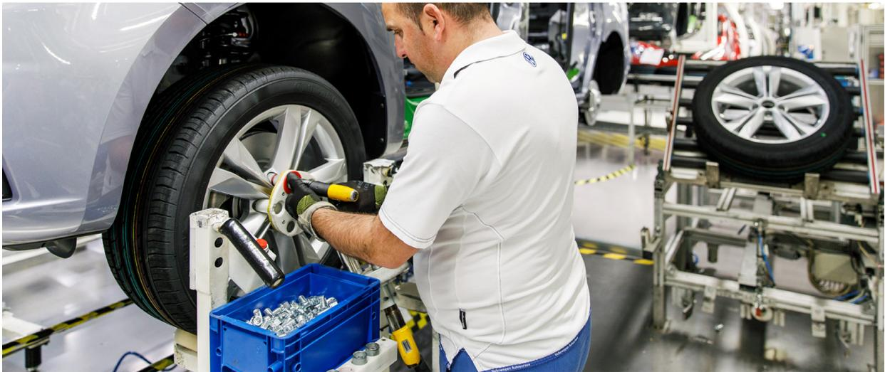
大众汽车公司使用 3D 打印的制造辅助设备大力提高生产效率。例如,图中所示的车轮保护夹具可防止划伤和损坏轮辋,同时对齐操作员的气动冲击枪,从而加快配合过程并降低报废成本。
