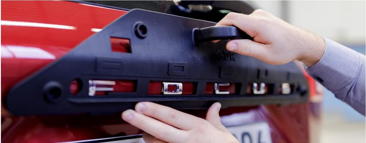
福特汽车公司应用了 50 多种 3D 打印的工具,用于大量生产新款福克斯。相比传统方法,制造其中的每件工具都节省了大量成本。上图所示的对齐工具可确保从装配线生产的每辆汽车的标志和贴花都保持一致。
